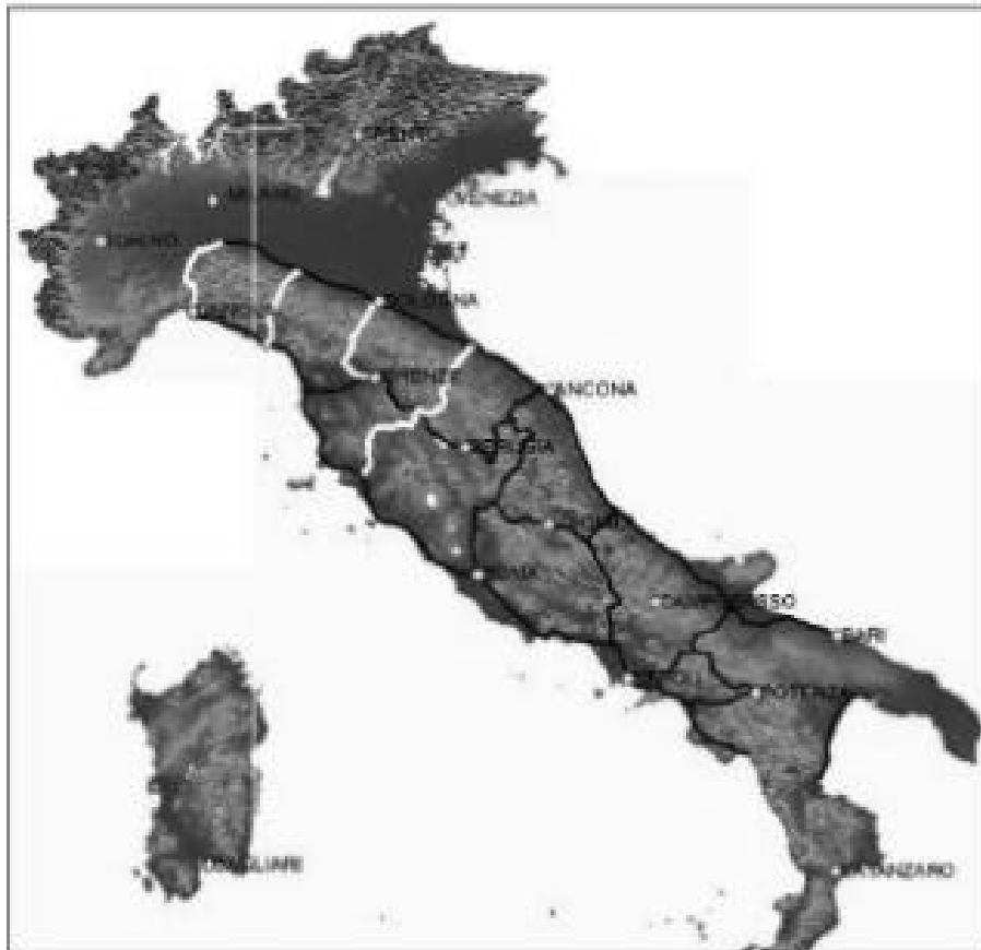
Figura 8 – Distribuzione delle linee di livellazione della rete fondamentale per cui disponiamo dei dati di almeno due campagne.
