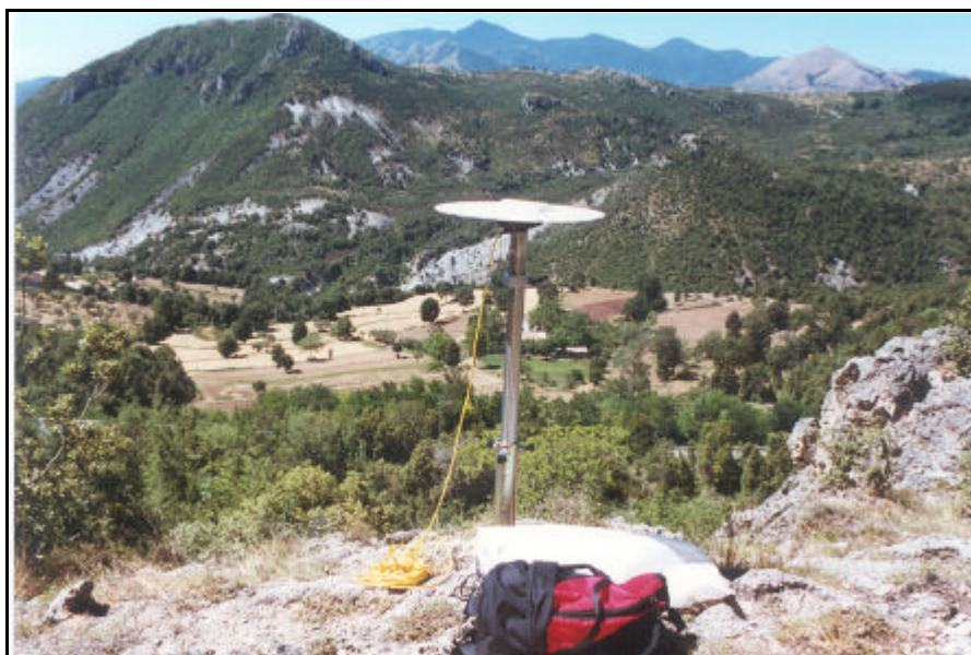
Fig. 5 – La struttura porta antenna per reti non permanenti.
