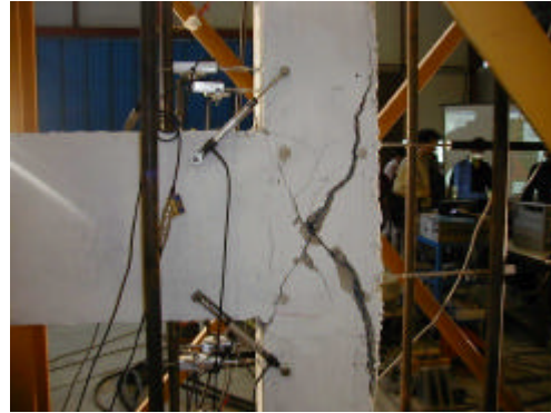
Figura 4.3.2. Comportamento sperimentale di un nodo trave-colonna con armature lisce.
