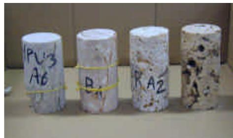
Figura 10. Prove di compressione monotona su cilindri di pietra prelevata in situ, provata nella direzione di lavoro essiccata e saturata.
