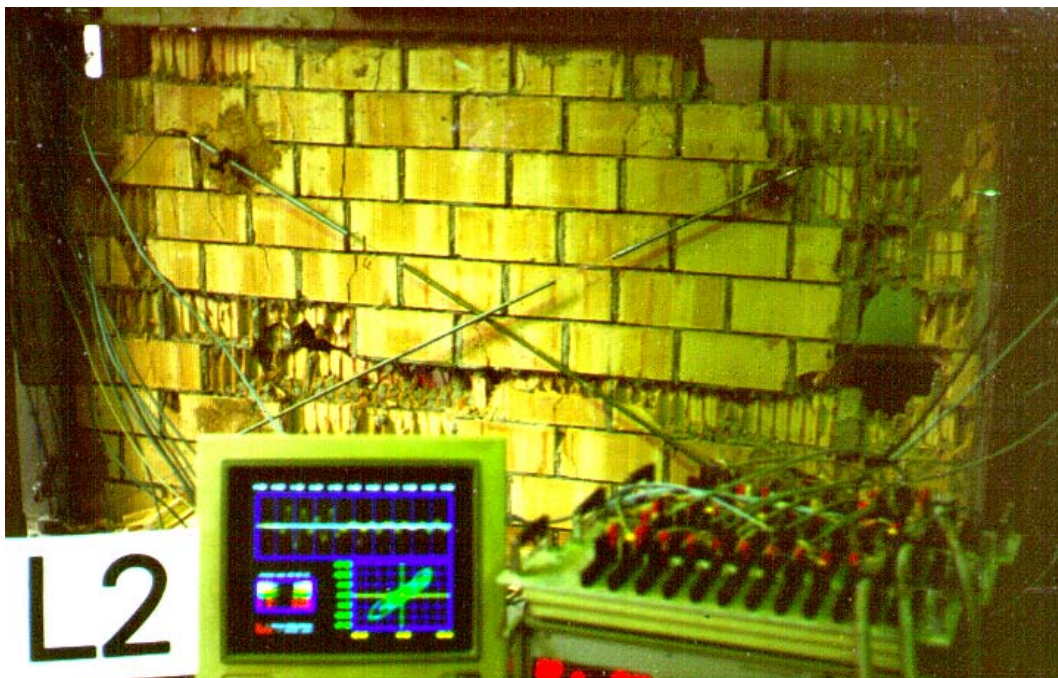
Fig. 2.16: Schiacciamento degli angoli e scorrimento nei campioni di Colangelo et al..
