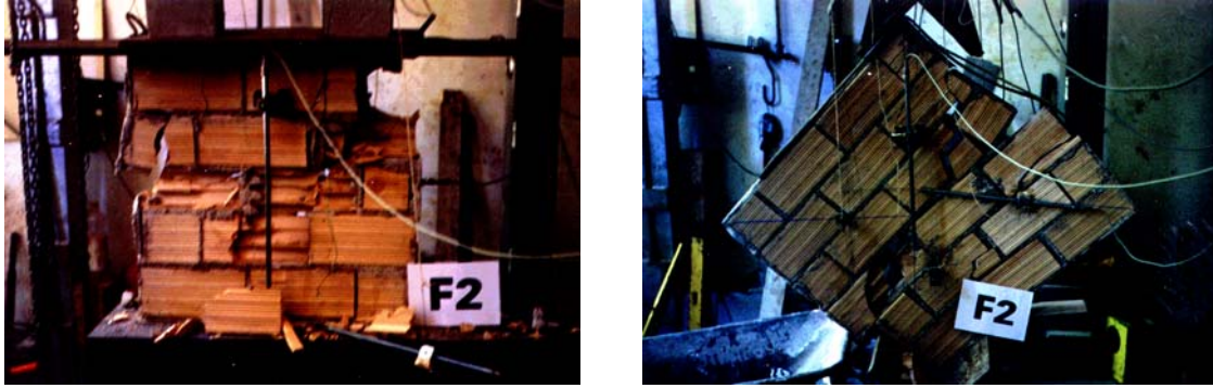
Fig. 3.1: Prove di compressione verticale (a sinistra) e diagonale (a destra) dei muretti.
