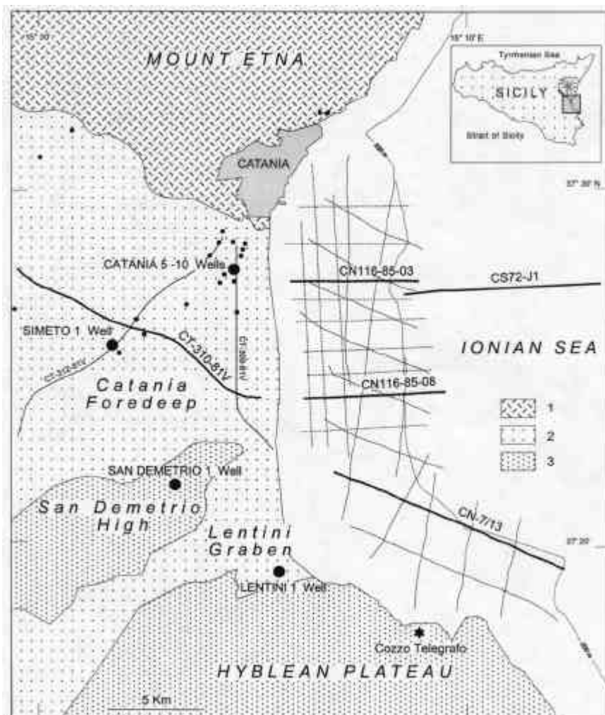
Fig. 1 – Ubicazione delle linee sismiche studiate nella Piana di Catania e sul bordo settentrionale ibleo e relativo offshore. Le linee CN 116-85-08 e CN 7/13 sono mostrate nelle Figure 2 e 3.
